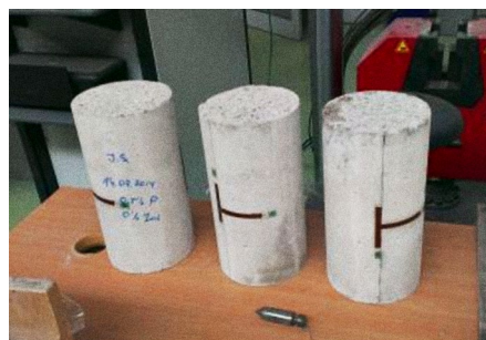
Rys. 2. Próbkę walcowe z naklejonymi tensometrami
